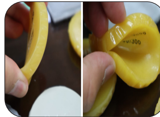
배합 비율에 따른 유연성 차이 왼 사진 (100:80) / 오른 사진 (100:300)
